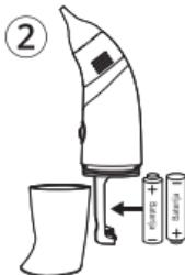
Postavite 2 alkalne baterije AA od 1,5 V vodeći računa o polaritetu baterija (+/-).
