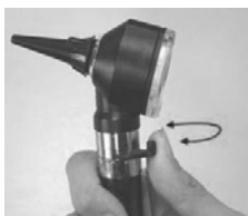
Kod novog tipa prekidača pomerite u levo
