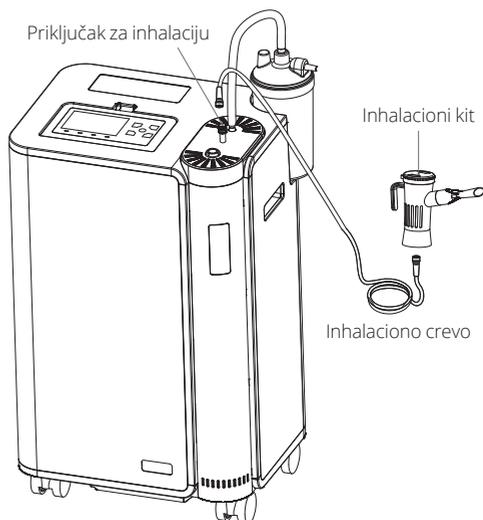
Tokom inhalacije može doći do aktiviranja lažnog alarma za nisku koncentraciju kiseonika. Nemojte preduzimati nikakve mere jer će se situacija normalizovati nakon prestanka inhalacije. Po završetku inhalacije, dobro zategnite metalni zatvarač na otvoru tj priključku za inhalaciju na aparatu da ne bi došlo do curenja gasa.
